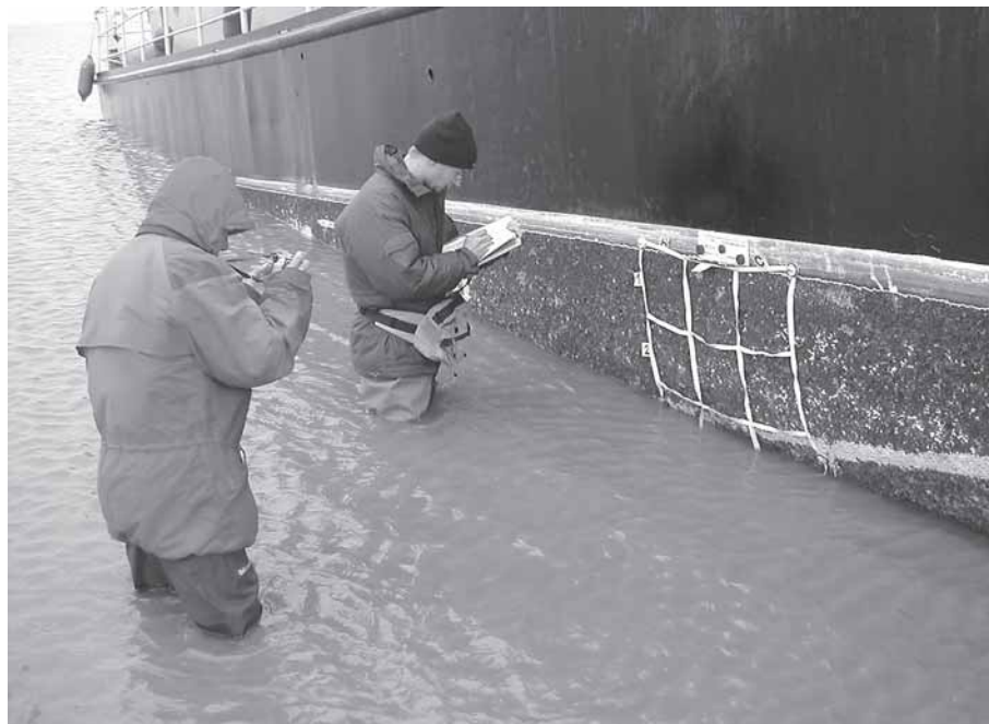
MS Buise, Steuerbordseite: Bernd Daehne und Frau Maike Meemken (beide LimnoMar Hamburg/Norderney) bei der Bewuchskontrolle und -dokumentation. Jedes Feld von dem aufgesetzten Messrahmen hat 25 cm x 25 cm Kantenlänge.
