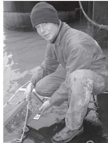
Auf einem Ponton im Hafen von Norderney: Frau Meemken zeigt einen PVC-Rahmen mit fünf Probestplatten mit unterschiedlichen Antifouling-Produkten. Das nahezu unbewachsene Segment (oben) enthält ein Antifouling bekannter Wirksamkeit als „Positivprobe“ zum Vergleich.
